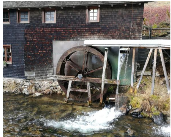
Beispiel für ein oberflächiges Mühlrad
